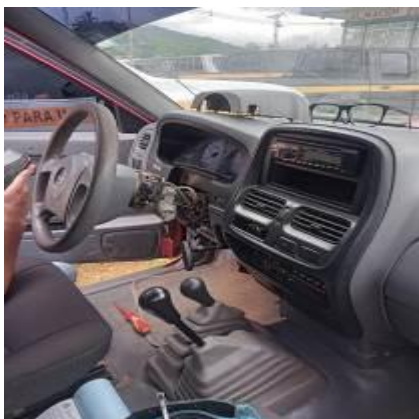
Técnico en proceso de instalación de Sistema de GPS a los vehículos de la Flota de las sedes provinciales.
