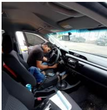
Técnico en proceso de instalación de Sistema de GPS a los vehículos de la Flota de las sedes provinciales.
